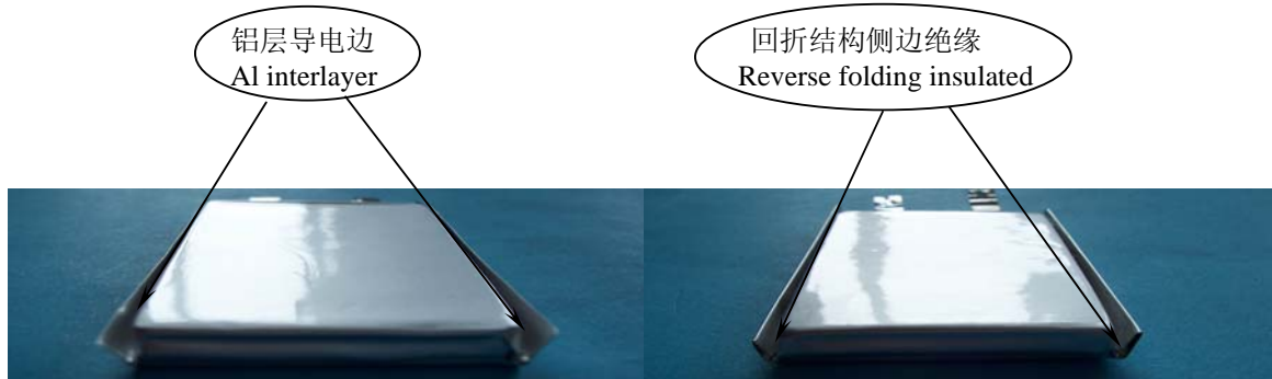
图 2: 锂聚合物电芯单层折边示意图
